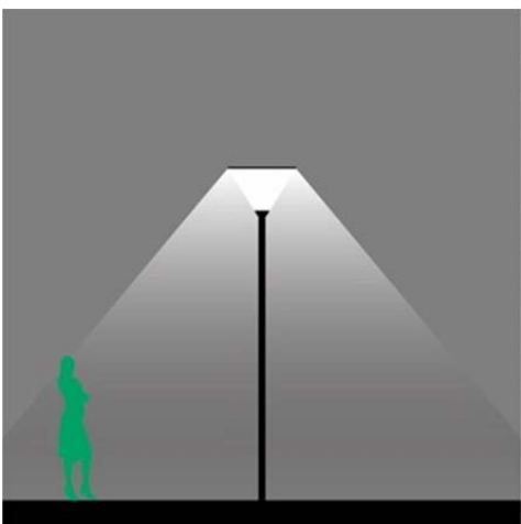
Figur 1: Parklygte, der giver et nedadrettet lys og har rotationssymmetrisk optik. Det betyder at den lyser 360 grader omkring masten, mens lyset, som det fremgår, ikke når over
